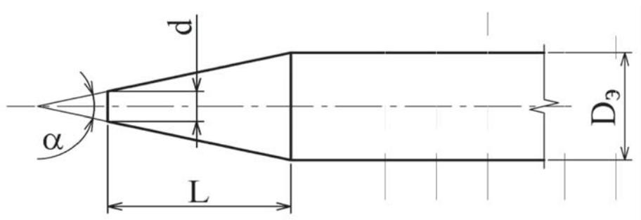
$D_э$  – диаметр электрода;  $d$  – диаметр притупления;  $L$  – длина конической части;  $\alpha$  – угол конуса
