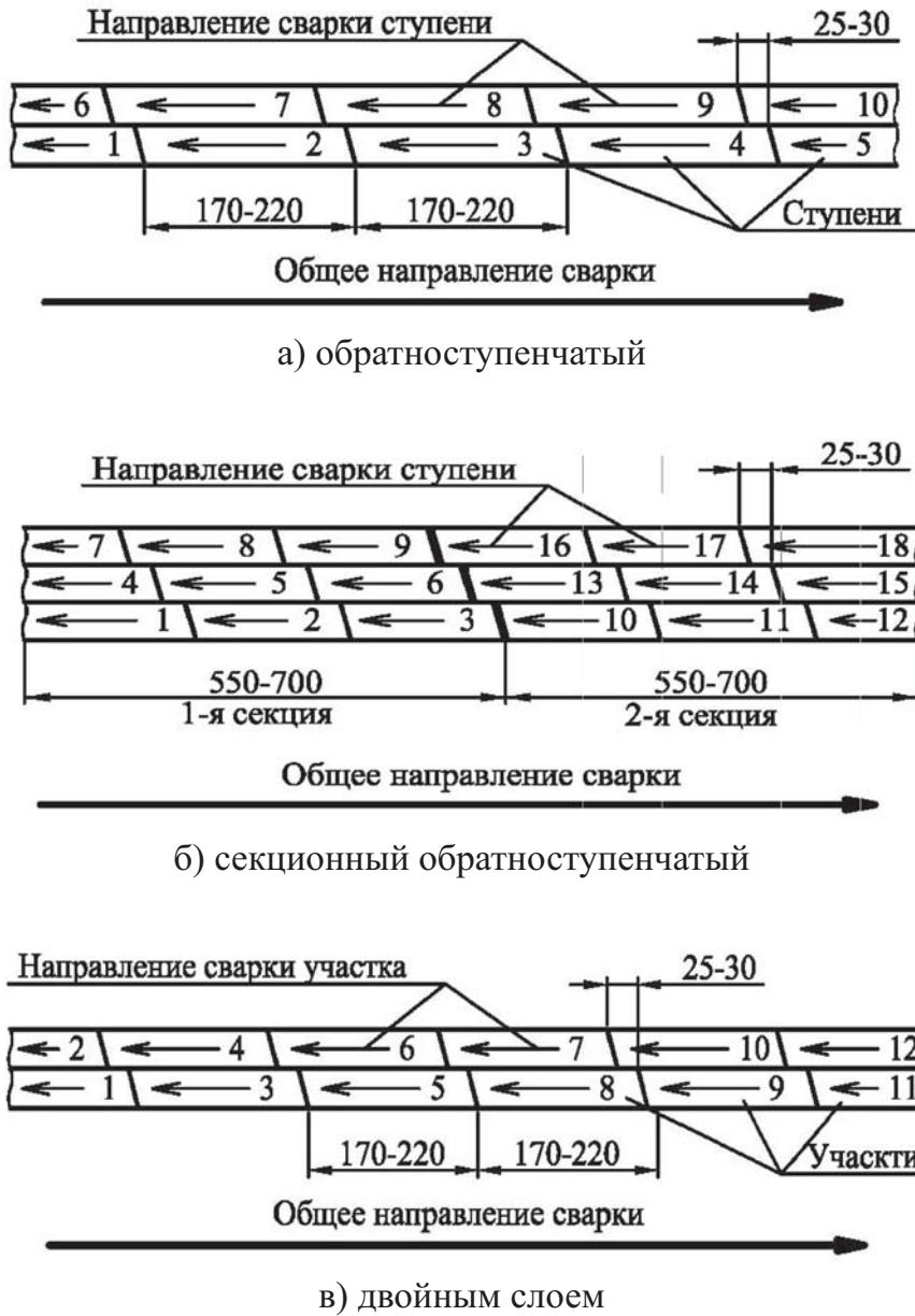
Рисунок 2, лист 1 – Способы выполнения швов сварных соединений
