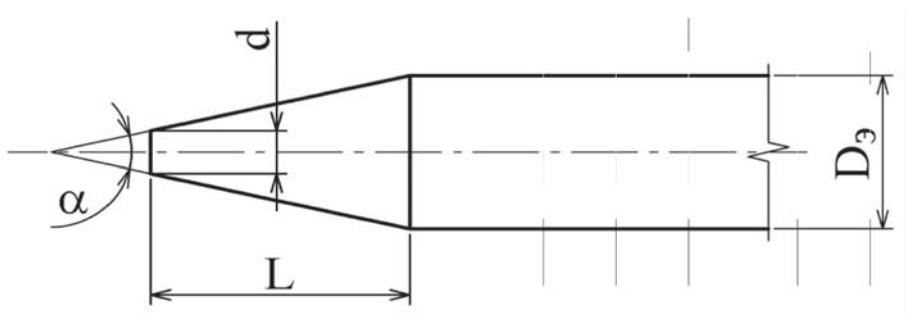
$D_e$  – диаметр электрода;  $d$  – диаметр притупления;  $L$  – длина конической части;  $\alpha$  – угол конуса
