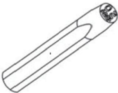
Рисунок 3 – Пример цифрового клейма для маркировки ударным способом
