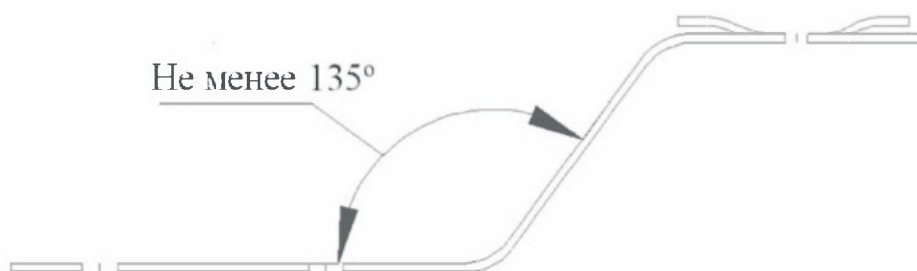
Рисунок Ж.2 – Рекомендуемый угол изгиба анкерной пластины
